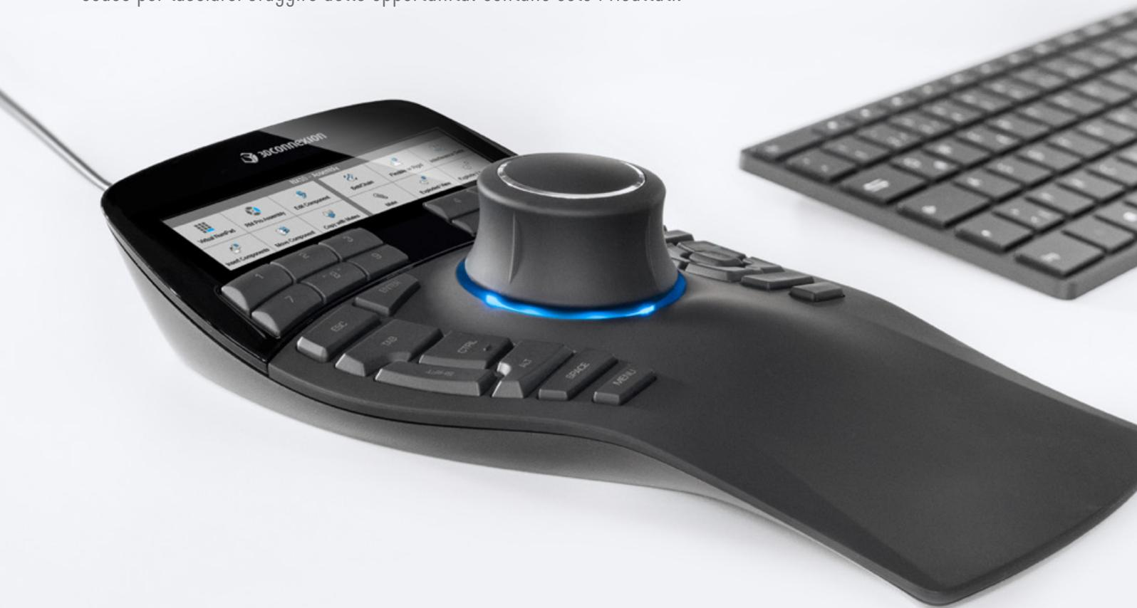
**Navigazione 3D professionale nel CAD:** Navigazione intuitiva e precisa di modelli o viste digitali con il sensore brevettato a sei gradi di libertà (6DoF).
