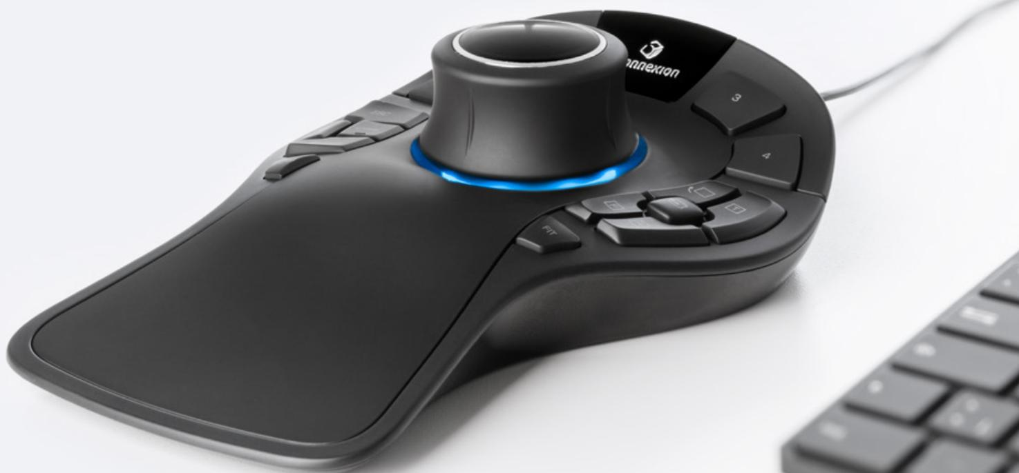
**Navigazione 3D professionale nel CAD:** Navigazione intuitiva e precisa di modelli o viste digitali con il sensore brevettato a sei gradi di libertà (6DoF).
