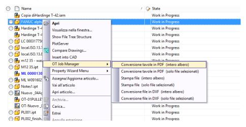
I files da inviare possono essere collezionati utilizzando le funzioni standard di ricerca di Vault o con la funzione di OT JM che permette di collezionare tutte le tavole di un assieme Inventor selezionato.
